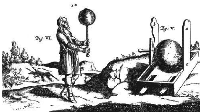
Рис. 4.7: Опыт Герики, где он держит перо в парящем состоянии над натертым серным шаром, и его электрическая машина.
