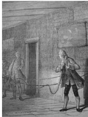
Рис. В.9: Грей натирает стеклянную трубку длиной 1 м из флинтгласа голыми руками. Шпагат, соединенный с трубкой, поддерживается шелковой нитью. Шар из слоновой кости на другом конце шпагата притягивает латунный листик под ним.
