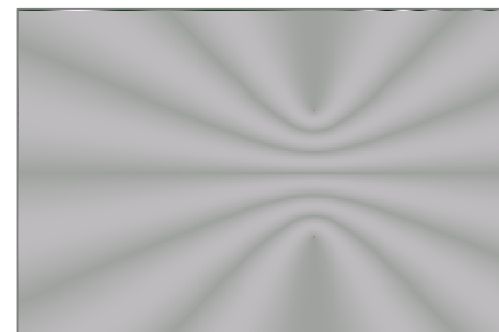
Фиг.2 Интерферируют волны равной длины. Картинка интерференции симметрична по всем координатам.
